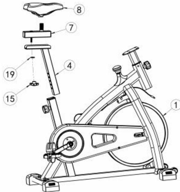
Рамката за регулиране на седлото (7) се монтира в стойката на седлото (4) и се фиксира с плоската шайба (19), регулираща гайка (15) и след това седлото (8) е разположено на Рамка за регулиране на седлото (7) и се фиксира и затяга с отворения ключ (25).
