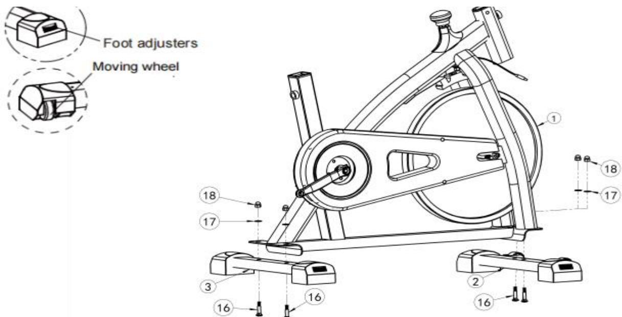
Предният стабилизатор (2) се фиксира към основното тяло (1) с болтове (16), плоски шайби (17) и гайки на капака (18) и се фиксиран с отворен гаечен ключ (25).
