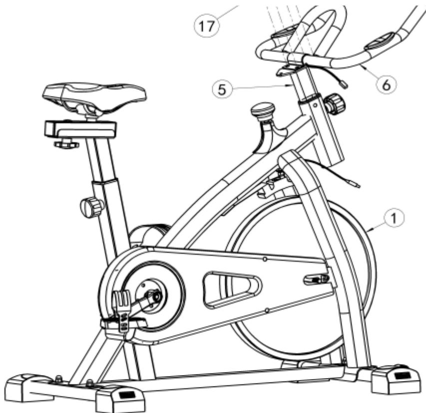
Рамката на дръжката (6) е фиксирана към стойката на дръжката (5) с плоски шайби (17), пружинни шайби (21) и болтове с бутонна глава (20) и затегнати с вътрешен шестоъгълен ключ (27).
