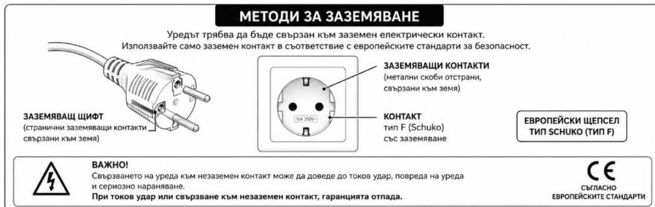
Фиг. 2. Принцилна схема на заземена връзка. Формата на щепсела и контакта може да се различава според държавата.
