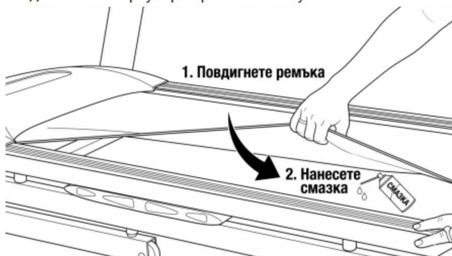
Смазване на лентата: 1 — повдигни лентата; 2 — нанеси смазка.
