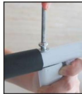
3. Фиксирайте дръжката с дълъг винт
